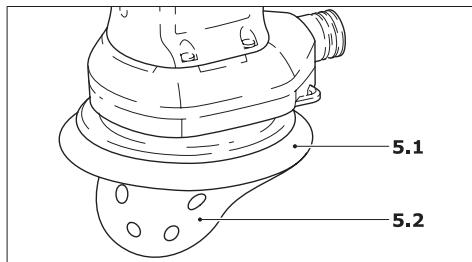
Los materiales abrasivos autoadheribles (5.2) se presionan simplemente sobre el plato de lijado (5.1) y son retenidos con seguridad por el recubrimiento adherente del plato de lijado Stickfix.
